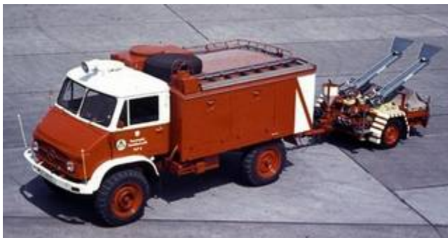
Mercedes Benz Unimog S 404.1 als Tanklöschfahrzeug TLF 8 des Katastrophenschutzes, hier mit einem intern als „Achilles-Flak“ bezeichneten Schaum-/Wasserwerfer-Anhänger SWA. Der Aufbau des TLF stammte von Magirus
