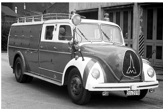
Die BF Dortmund setzte schon sehr früh die Rot-Weiß-Lackierung an ihren Fahrzeugen um. Hier ein TLF 15 mit Sprechfunk-Antenne auf der Motorhaube.
